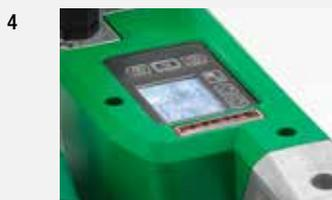
**4** **UNIROOF AT :** un **tableau de commande à écran** pratique avec l'affichage numérique des paramètres de soudure et l'indication de la tension pour un contrôle en continu. Économisez donc du temps avec des profils de soudure programmables correspondant aux membranes de toitures les plus couramment employées.
