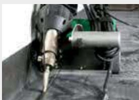
L'**écart minimal par rapport au mur de seulement 51 mm** permet un soudage facile des gorges les plus courantes et même des jonctions verticales. La faible hauteur de l'unité permet un soudage continu dès lors que le passage mesure au moins 295 mm de hauteur.
