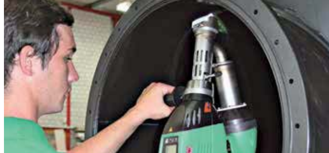
Soudage simple même des rayons intérieurs.
