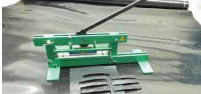
Éprouvette de dimensions uniforme, fabriquée rapidement avec le Coupon Cutter.
