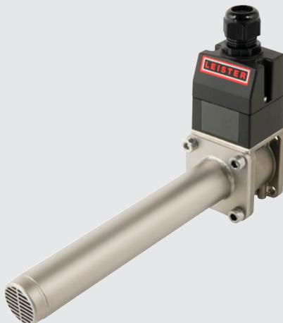
Le LHS 210 SF HT a une puissance de 3.3 kW, il atteint une température de sortie d'air maximale de 900 °C et peut être équipé de différentes buses. Avec un SSR, le réchauffeur d'air peut être intégré dans un circuit de régulation au moyen d'un signal PWM.
