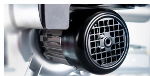
Le moteur de la soufflerie peut être commandé par un convertisseur de fréquence externe
