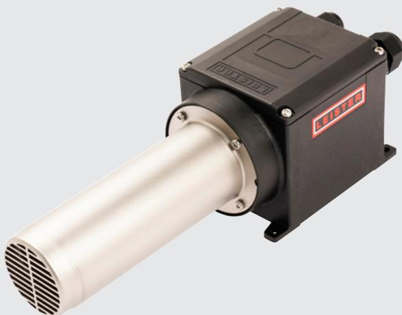
Le LHS 41L CLASSIC a un tube de chauffage plus long et est disponible avec une puissance de 2, 4.4 ou 5.5 kW. Il dispose d'une détection de la surchauffe de l'élément chauffant et de l'appareil avec un contact d'alarme. Il s'intègre parfaitement dans le circuit de régulation via SSR.
