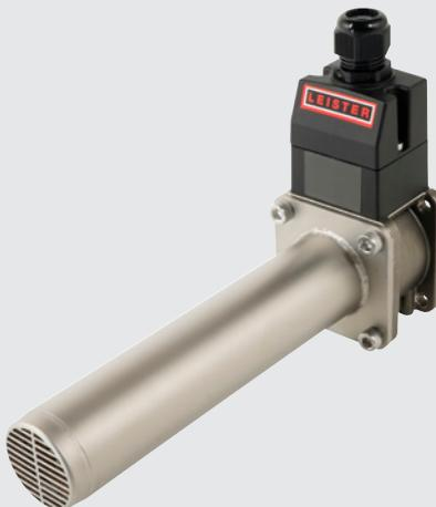
Le LHS 410 SF HT a une puissance de 4.4 ou 5.5 kW, une température de sortie d'air maximale de 900 °C et peut être équipé de différentes buses. Avec un SSR, le réchauffeur d'air peut être intégré dans un circuit de régulation au moyen d'un signal PWM.
