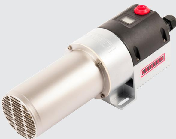
Le LHS 61L SYSTEM est disponible avec une puissance de 5, 8, 10, 11 ou 16 kW. Il dispose d'un écran pour l'affichage des valeurs de consigne/réelles, d'une interface de commande à distance et d'une protection contre la surchauffe de l'élément chauffant et de l'appareil avec contact d'alarme.
