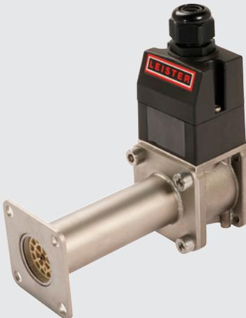
Le LHS 210 DF est disponible avec une puissance de 1, 2 ou 3.3 kW. Grâce à sa bride, il est facile à installer dans des systèmes de tuyaux. Avec un SSR, le réchauffeur d'air peut être intégré dans un circuit de régulation au moyen d'un signal PWM.
