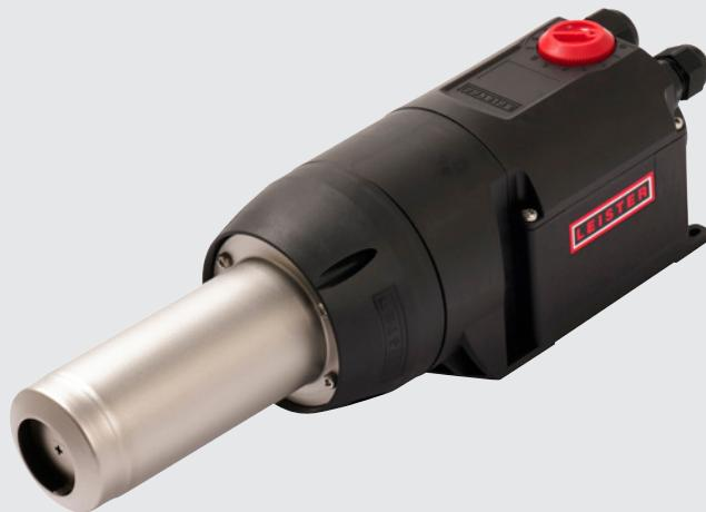
Le MISTRAL 6 PREMIUM dispose d'une protection de l'élément chauffant et de l'appareil et se distingue du MISTRAL 2 PREMIUM par un moteur sans balais et sans entretien, ce qui le rend adapté à un fonctionnement continu. Il est disponible en deux diamètres de tube de chauffage différents.
