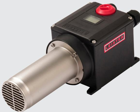
Le LHS 41S SYSTEM est disponible avec une puissance de 2 ou 3.6 kW. Il dispose d'un écran pour l'affichage des valeurs de consigne/réelles, d'une interface de commande à distance et d'une protection contre la surchauffe de l'élément chauffant et de l'appareil avec contact d'alarme.
