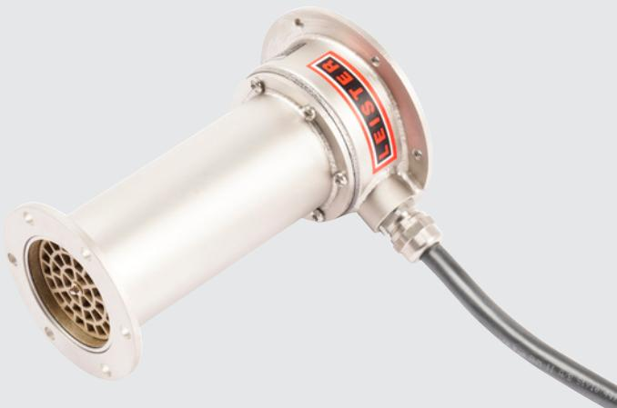
Le LE 5000 DF a une puissance de chauffage de 4.5, 6.5, 7.5 ou 8 kW. Il atteint une température maximale de sortie d'air de 700 °C et peut fonctionner à une température d'entrée de 150 °C maximum. Il convient à l'intégration dans des systèmes de conduits d'air.
