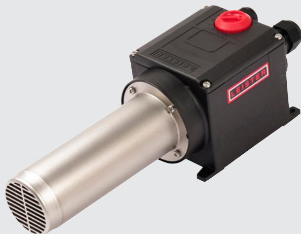
Le LHS 41L PREMIUM a un tube de chauffage plus long et est disponible avec une puissance de 2, 4.4 ou 5.5 kW. Il possède une protection contre la surchauffe de l'élément chauffant et de l'appareil avec un contact d'alarme. La puissance de chauffage est réglable en continu à l'aide d'un potentiomètre sur l'appareil.
