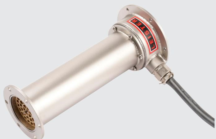
Le LE 5000 DF HT a une puissance de chauffage de 7, 7.5 ou 11 kW. Il atteint une température maximale de sortie d'air de 900 °C et peut fonctionner à une température d'entrée de 150 °C maximum. Il convient à l'intégration dans des systèmes de conduits d'air.
