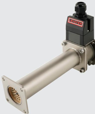
Le LHS 410 DF HT a une puissance de 4.4 ou 5.5 kW, une température maximale de sortie d'air de 900 °C et, grâce à sa bride, il est facile à installer dans des systèmes de tuyaux. Avec un SSR, le réchauffeur d'air peut être intégré dans un circuit de régulation au moyen d'un signal PWM.
