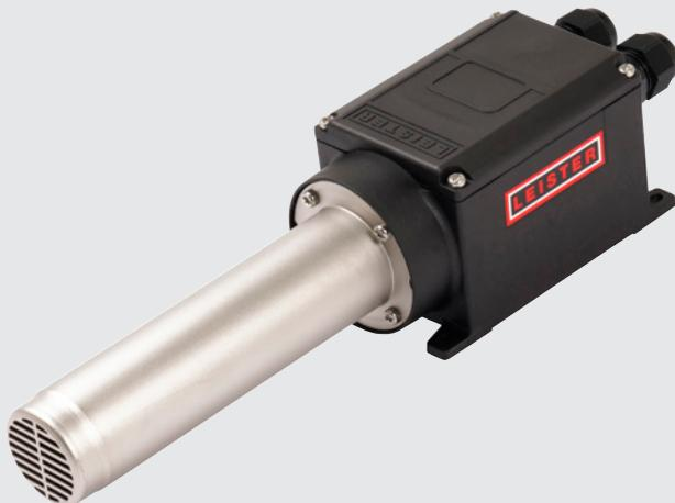
Le LHS 21L CLASSIC 3.3 kW dispose d'un tube de chauffage plus long. Il dispose d'une détection de la surchauffe de l'élément chauffant et de l'appareil avec un contact d'alarme. Il s'intègre parfaitement dans le circuit de régulation via SSR.
