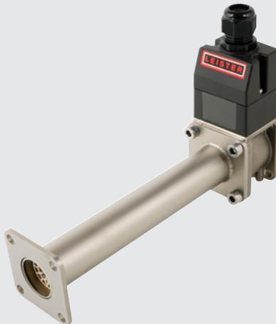
Le LHS 210 DF HT a une puissance de 3.3 kW, il atteint une température maximale de sortie d'air de 900 °C et sa bride permet de l'installer facilement dans des systèmes de tuyaux. Avec un SSR, le réchauffeur d'air peut être intégré dans un circuit de régulation au moyen d'un signal PWM.
