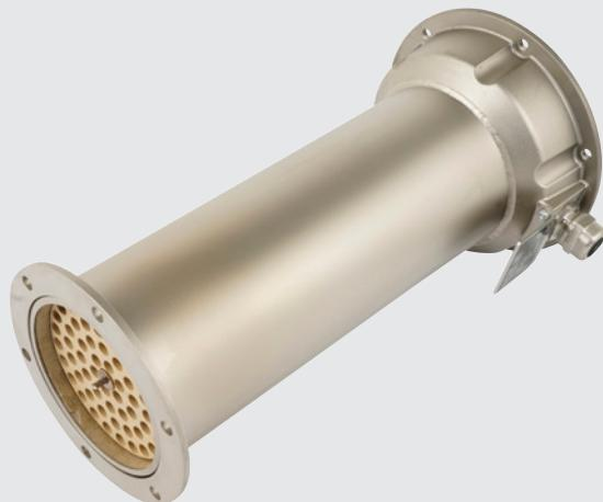
Le LE 10000 DF a une puissance de chauffage de 5.5, 8, 11, 16 ou 17 kW. Il atteint une température maximale de sortie d'air de 650 °C et peut fonctionner à une température d'entrée de 150 °C maximum. Il convient à l'intégration dans des systèmes de conduits d'air.
