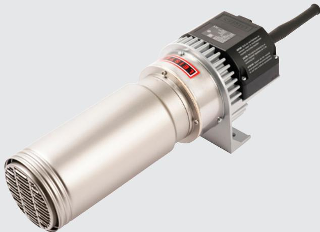
Le LE 10000 HT a une puissance de chauffage de 15 kW. Il atteint une température maximale de sortie d'air de 900 °C et peut fonctionner à une température d'entrée de 100 °C maximum. Le réchauffeur d'air peut être équipé de différentes buses.
