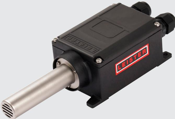
Le LHS 15 CLASSIC est disponible en 550 ou 770 W. Il dispose d'une détection de la surchauffe de l'élément chauffant et de l'appareil avec un contact d'alarme. Il s'intègre parfaitement dans le circuit de régulation via SSR.
