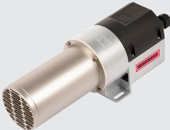
Le LHS 61L CLASSIC est disponible avec une puissance de 5, 8, 10, 11 ou 16 kW. Il dispose d'une détection de la surchauffe de l'élément chauffant et de l'appareil avec un contact d'alarme. Il s'intègre parfaitement dans le circuit de régulation via SSR.
