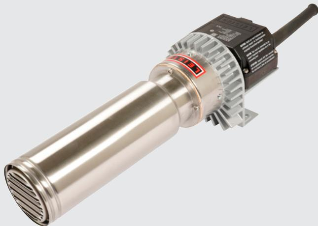
Le LE 5000 HT a une puissance de chauffage de 11 kW. Il atteint une température de sortie d'air maximale de 900 °C et peut fonctionner à une température d'entrée allant jusqu'à 100 °C. Le réchauffeur d'air peut être équipé de différentes buses.
