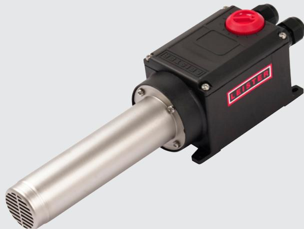
Le LHS 21L PREMIUM 3.3 kW dispose d'un tube de chauffage plus long. Il possède une protection contre la surchauffe de l'élément chauffant et de l'appareil avec un contact d'alarme. La puissance de chauffage est réglable en continu à l'aide d'un potentiomètre sur l'appareil.
