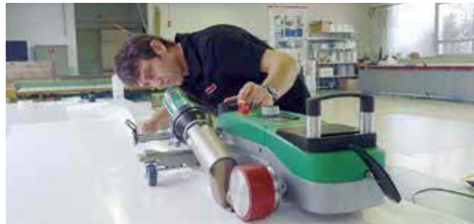
Soudage facile d'ourlets et de languettes à l'aide du kit ourlet/languette.
