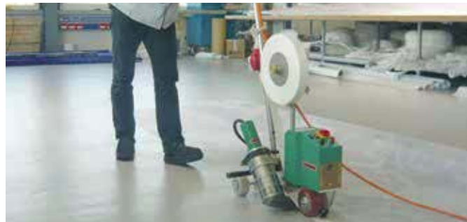
Soudage de sangles à vitesse maximale.
