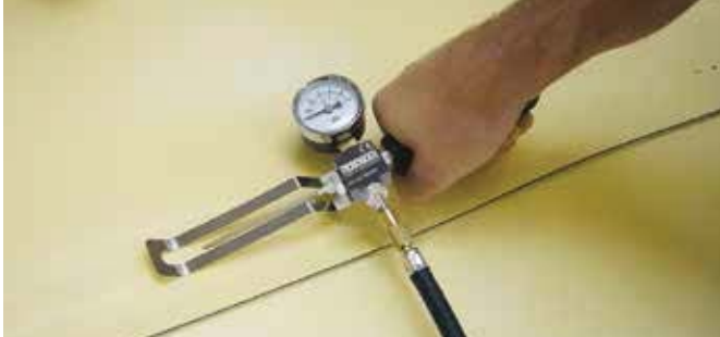
Test de l'étanchéité de soudures par recouvrement avec canal de contrôle.
