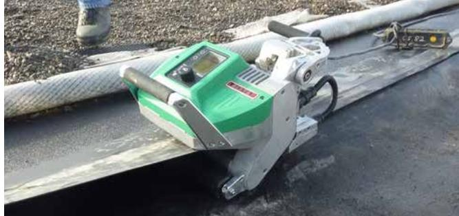
Lors d'un essai sur le terrain (Afrique du Sud), la GEOSTAR soude sans aucune difficulté une longueur de 240 m en une seule phase.
