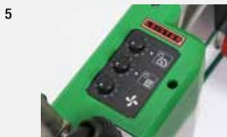
**5 UNIROOF ST** pour les puristes : Moteur à système en boucle fermée. Température et soufflerie à système en boucle ouverte. Régulation simple avec potentiomètres/boutons rotatifs.
