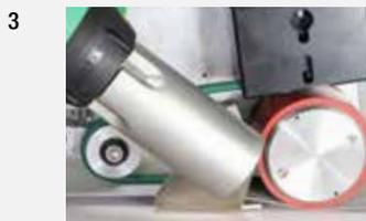
**3 UNIROOF AT :** Le système à boucle fermée à régulation totale pour le moteur, la température et le débit d'air de la soufflerie maintiennent les paramètres de soudure constants, soudent en toute fiabilité afin de garantir des processus et des investissements sûrs aux maîtres d'ouvrage et aux entrepreneurs.
