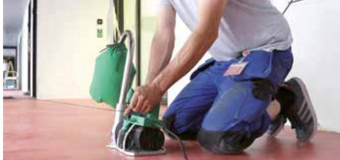
L'entraînement puissant convient pour les matériaux PVC, PUR et le linoléum.
