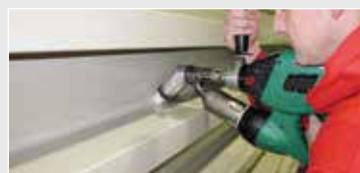
Le soudage est facilité dans les positions difficiles: grâce à la tête angulaire à 45° de la WELDPLAST S2. (Accessoire)
