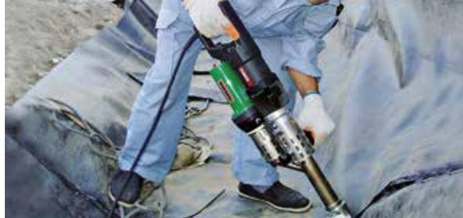
Grâce à sa longueur, la FUSION 3 est spécialement adaptée aux utilisations dans le génie civil.
