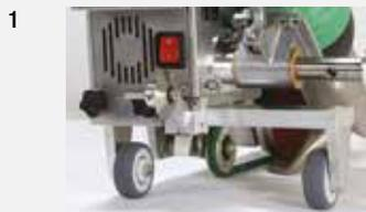
**1 Plus de temps perdu à transformer l'appareil :** La soudeuse automatique de toits ultra mince, équipée d'un socle roulant de transport coulissant, maîtrise sans efforts les soudures près du bord jusqu'à 100 mm, sur ou près de l'acrotère ou sur la surface et partout où l'étroitesse règne.
