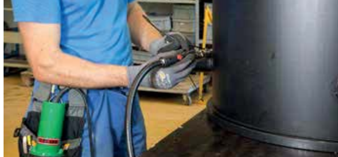
LABOR S combiné au MINOR comme alimentation en air externe.
