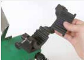
**Rétrocompatible** : même les modèles TRIAC plus anciens peuvent être raccordés sans problème grâce à des inserts interchangeables.
