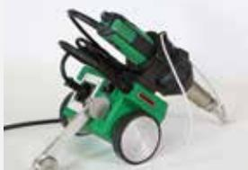
**Incroyablement rapide** : malgré son poids réduit, le dispositif MINIFLOOR permet une vitesse de soudage d'environ 2 m/min, soit presque le double de la vitesse en soudage manuel.
